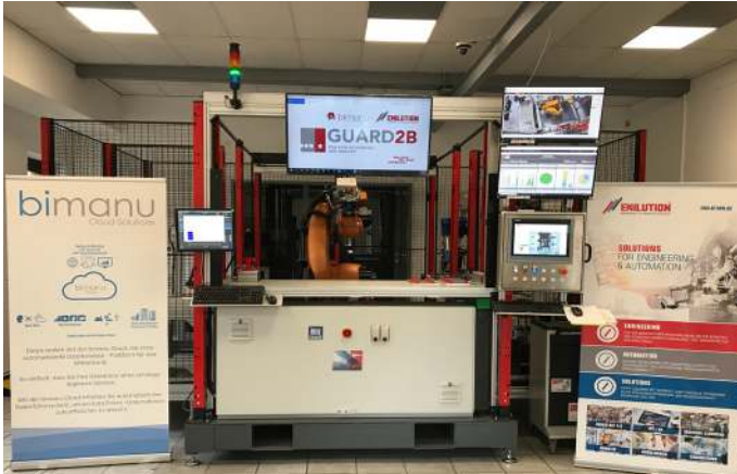
Abbildung 1: Testmaschine von Wichelhaus: Die modulare Anlage verfügt über zehn Stationen, die von einem Industrieroboter bedient werden. Für verschiedene Programme und Stationen erfolgt eine vollautomatisierte Umrüstung.
